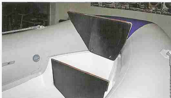
Оригинальная конструкция носового рундука на «SkyBoat-360R» позволяет при необходимости задействовать всю длину кокпита
