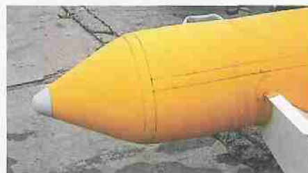
Оконечности надувных баллонов имеют значительный «вылет» за транец
